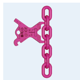
Prüfen Plastische Längung durch Überlast
