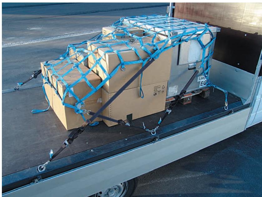
Gurtbandnetz auf Pritschenaufbau eingesetzt.
