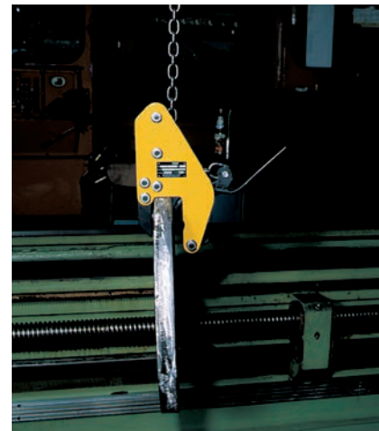
Allzweckgreifer als Sonderkonstruktion mit geringen Baumaßen für den Einsatz an schwer zugänglichen Stellen (z.B. Drehbank).
