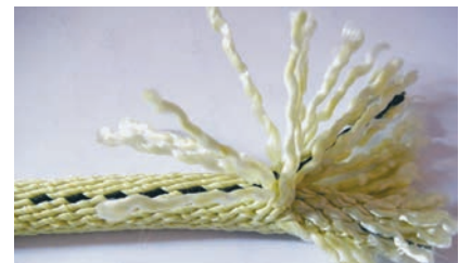
Paraloc - Seilmantel und Kern sind miteinander durch Zwischenfasern verbunden
