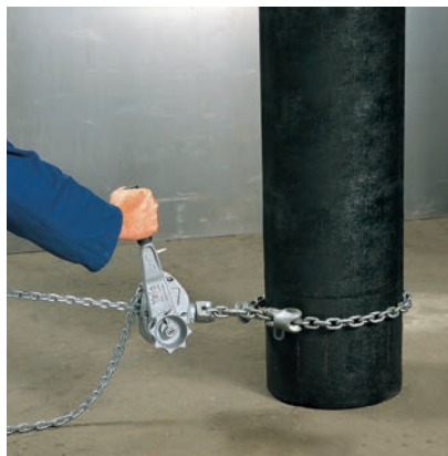
Zughub D 95: Anwendung mit Schlingkette.
