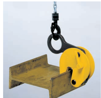
Bei langen Trägern empfiehlt sich der paarweise Einsatz in Verbindung mit einer Traverse.
