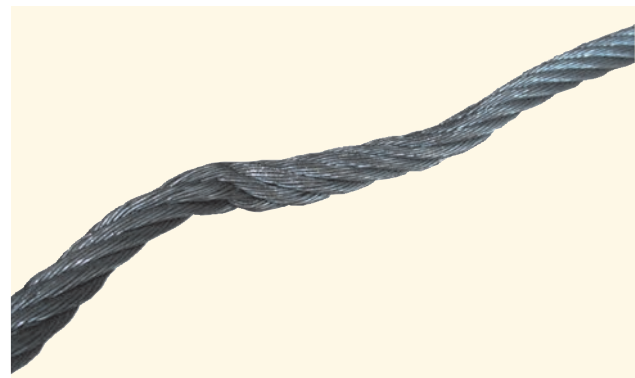
Die Ablegereife ist erreicht: Quetschung des Seils
