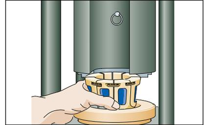
Pressbackensatz in die eingefettete Werkzeugaufnahme einsetzen und auf gleichmäßige Verteilung der Einzelsegmente achten. Backen sind nach Schlauchgröße farbig gekennzeichnet (s. Pressmaß-Tabelle).
