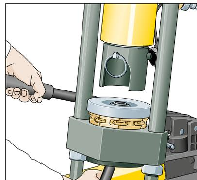
5. Mittels Blockierstift Pressstempel ausrichten. Rücklaufventil an der Pumpe schließen, Handpumpe betätigen bis Backenring auf Grundplatte aufsetzt.
