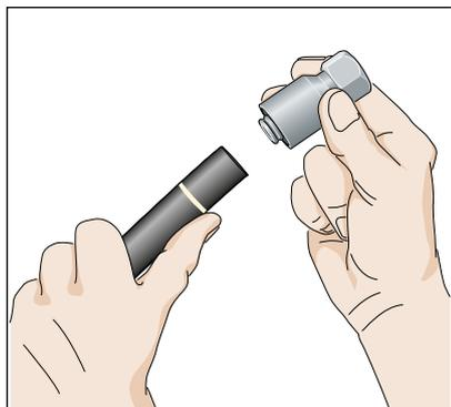
1. Einstecktiefe der Armatur gemäß Krimptabelle markieren (mit Ölkreide o.ä.) und Armatur auf das Schlauchende schieben bis das Hülsende die Markierung erreicht. Falls erforderlich, wird das Armaturende mit einem Tropfen Öl benetzt (z. B.: Hoze Oil). Bei der Verarbeitung von Spiralschläuchen soll keine Schmierung verwendet werden.
