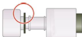
Schieben Sie den Nippel in den Schlauch bis zum Anschlag an der unteren Nut (Kunststoffring, Schulter der Armatur oder Metallanschlag). Verwenden Sie ggf. Hoze-Oil.
