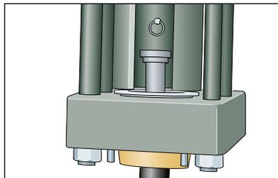
Presse mittels Knopf (linker Schalter) in Betrieb setzen. Dann am rechten Schalter unteren Knopf drücken bis Stempel gegen Anschlag fährt.
