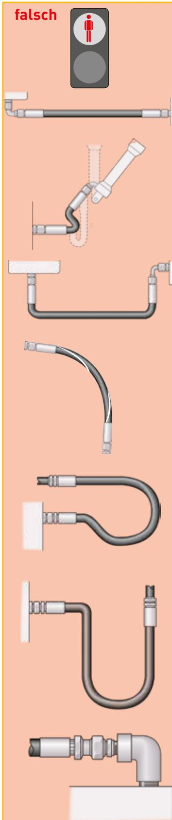
Das **Verlegen** der Schlauchleitung und die Umgebung, in der sie betrieben wird, beeinflussen unmittelbar die Lebensdauer einer Schlauchleitung. Die folgenden Diagramme zeigen die sachgemäße Verlegung von Schlauchleitungen, die deren Lebensdauer maximieren und eine sichere Funktionsfähigkeit gewährleisten.
