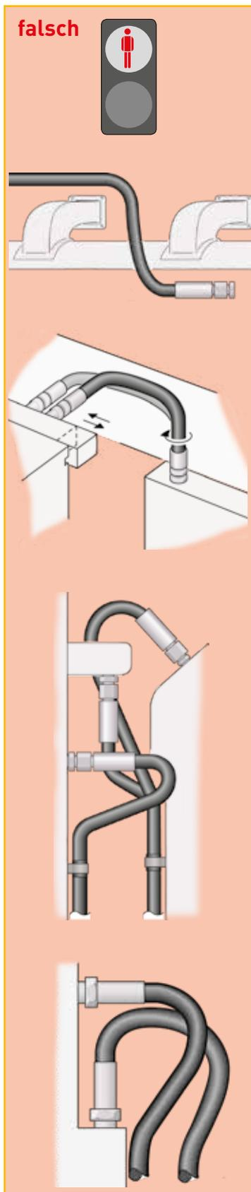
Das **korrekte Befestigen** des Schlauches (für Halt/Unterstützung) sollte beachtet werden, damit der Schlauch sicher verlegt bzw. vermieden wird, dass der Schlauch mit Oberflächen in Berührung kommt, die zu seiner Beschädigung führen.
