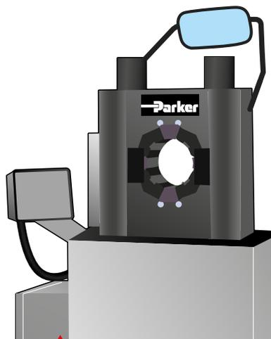
Zur Verpressung der Armaturenserie ParLock V4 benötigt man mindestens eine Presskraft von 320 t. Für die Serie V6 sind dies mindestens 350 t.
