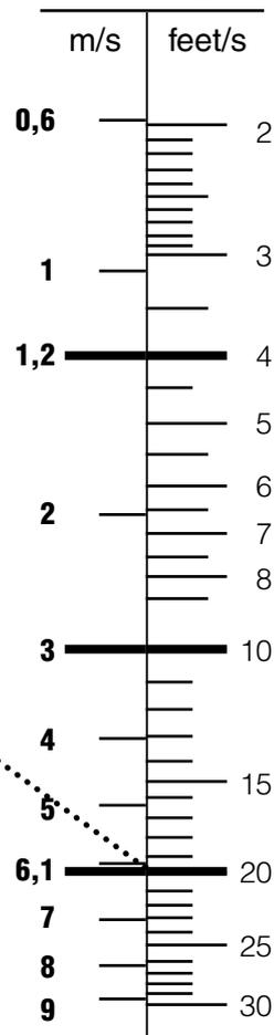
max. empfohlene Strömungsgeschwindigkeit bei Saugleitungen
