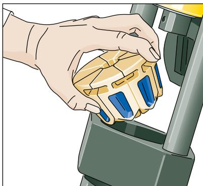
2. Blockierstift abziehen, Pressbackensatz in die eingefettete Werkzeugaufnahme einsetzen und auf gleichmäßige Verteilung der Einzelsegmente achten. Pressbacken sind farbig gekennzeichnet (s. Tabelle). Die Öffnung der verketteten Backensätze nach vorne einlegen.
