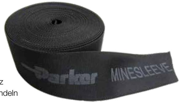
Parker Minesleeve bietet höchste Abriebfestigkeit ohne die Beweglichkeit der Schlauchleitung zu beeinflussen und übertrifft die Forderungen der MSHA, hinsichtlich Flammwidrigkeit und Selbstverlöschung. Berstdruckprüfungen nach SAE J343, ausgeführt an Schlauchleitungen mit DMS Überzug zeigten 7-fach höheren Schutz gegen Ölspritzer als vergleichbare Überzüge. DMS kann auch zum Bündeln von Schlauchleitungen, sowie Rohre und Kabel verwendet werden.
