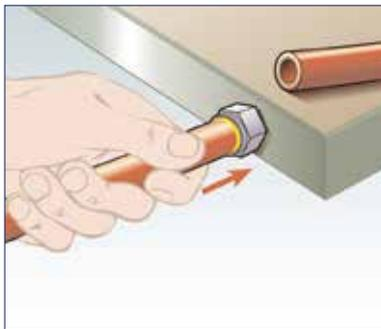
2. Nippel in den Schlauch stecken und zügig bis zum Anschlag eindrücken. Dabei sollte der Schlauch etwa 2,5 cm hinter der Schnittstelle gehalten werden. Alternativ verwenden Sie das Parker Montagegerät 611050G.
