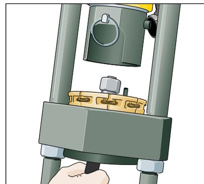
3. Schlauch von unten einführen und zwischen die Pressbacken und Armatur auf den Backenanschlag (Stop) aufsetzen.
