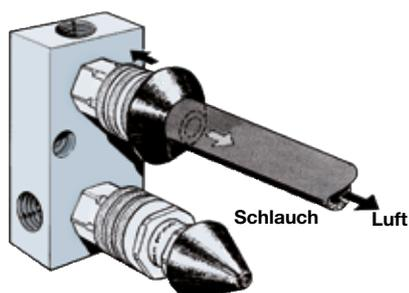
Nach dem Schneiden wird empfohlen, den Schlauch von beiden Seiten mit Druckluft auszublasen. Hierfür empfehlen wir die Reinigungsvorrichtung TH6-7 – Ein schnelles und einfaches System – Die Vorrichtung hat 2 Kunststoffdüsen für Schläuche von size -4 (DN 6) bis size -32 (DN 50). Der Schlauch wird gegen die Düse gedrückt. Hierdurch wird ein Ventil geöffnet, damit per Druckluft lose Partikel aus dem Schlauch geblasen werden.
