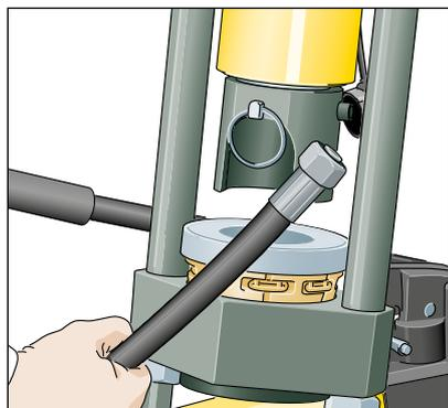
6. Rücklaufventil mittels Flügelschraube am Pumpenausgang druckentlasten. Fertig gepressten Schlauchanschluß nach unten herausziehen.
