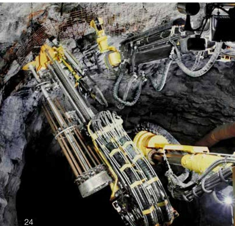
Die Bergbau-Schläuche, Armaturen und Adapter von Parker bieten Ihnen ein komplettes und zuverlässiges Hydraulikpaket zum Anschluss und zur Unterstützung Ihrer Bergbaugeräte. Sämtliche Bergbau-Schlauchprodukte von Parker verbinden internationale Zulassungen mit einem einheitlichen System und einer langen Lebensdauer unter aggressiven Bedingungen.
