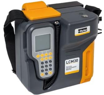
Der Parker icountLaserCM30 ist ein innovatives System zur Kontaminationsüberwachung von Flüssigkeiten mit einem Testverfahren, das weniger als 90 Sekunden dauert. Dieses Partikelzählgerät der neuesten Generation bietet vielfältige Funktionen wie Zustandsberichte nach mehreren Normen (ISO 4406, NAS 1638, AS4059 und GOST), die Möglichkeit zur Dateneingabe durch den Anwender und einen integrierten Drucker.
